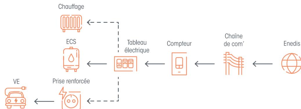
Pour les bâtiments non équipés d'HEMS, le compteur Linky est en mesure de transmettre les signaux de la grille du fournisseur d'électricité (index, pas de prix en €).
